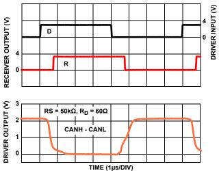
FIGURE 43. SLOW DRIVER AND RECEIVER WAVEFORMS
