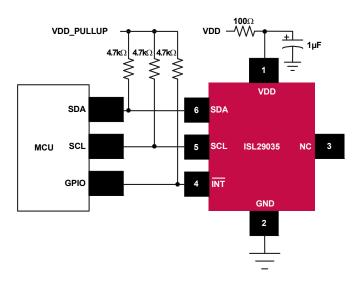
FIGURE 16. ISL29035 TYPICAL CIRCUIT
