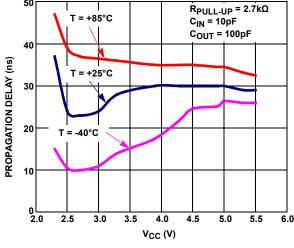
FIGURE 23. PROPAGATION DELAY H-L vs V<sub>CC</sub>
