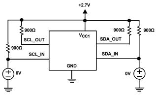
FIGURE 6A. TEST CIRCUIT
