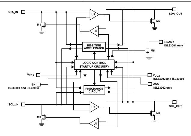
FIGURE 10. CIRCUIT BLOCK DIAGRAM
