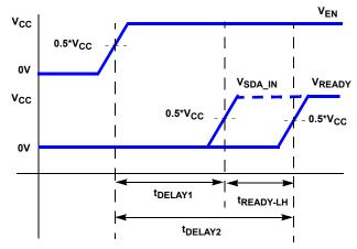
FIGURE 3. ENABLE DELAY TIME
