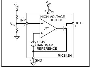
FIGURE 1-6: MIC842N Block Diagram
