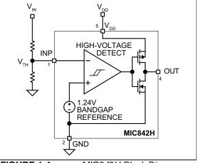
FIGURE 1-4: MIC842H Block Diagram
