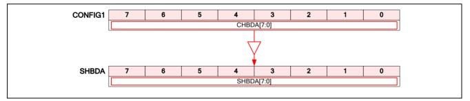
Figure 25–2 CONFIG1 Reset Reloading
