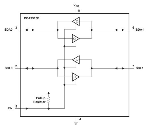
Figure 4. Logic Diagram (Poisitve Logic)
