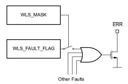
Figure 21. Weak-LED-Supply Fault-Report Topology
