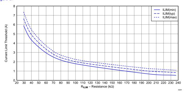
Figure 6. Current-Limit Threshold Versus R<sub>ILIM</sub>
